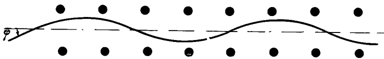
Рис. 1. Схематичное изображение канала и траектории движущейся по каналу частицы (изображение траектории сильно сжато в горизонтальном направлении).
