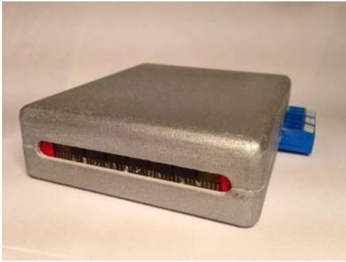
Рис. 1. Внешний вид экспериментального образца высокоточного преобразователя перемещений на основе микроразмерных высокочувствительных сенсоров магнитного поля для устройств исполнительной прецизионной автоматики.
