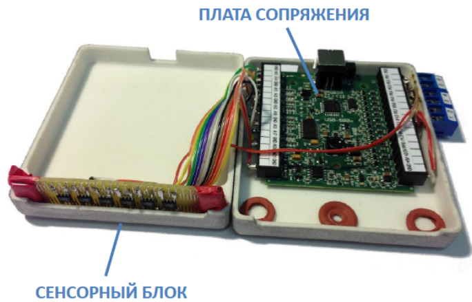
Рис. 2. Составные элементы экспериментального образца высокоточного преобразователя перемещений на основе микроразмерных высокочувствительных сенсоров магнитного поля для устройств исполнительной прецизионной автоматики
