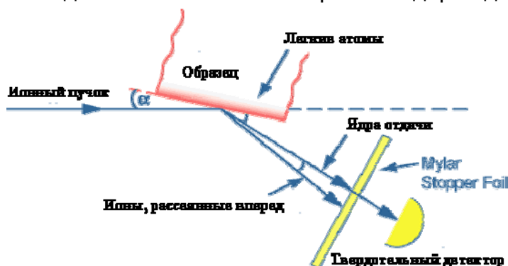
Рис.VIII. Схема, поясняющая метод ERDA.
