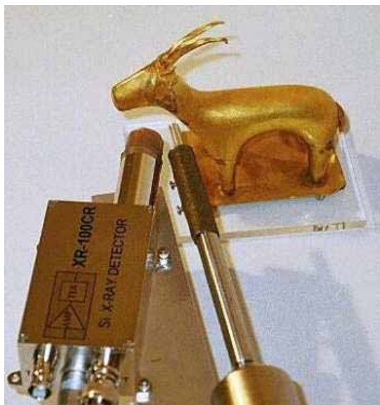
Рис.IV. Исследование методом PIXE исторических артефактов. Золоченая бронзовая статуэтка облучается протонами высокой энергии, выведенными в воздух из ускорителя ионов. Рентгеновский детектор высокого разрешения (~120 эВ) регистрирует кванты, рожденные при столкновении ионов с атомами покрытия. В музее Лувра (Париж) была создана первая в мире лаборатория для материаловедческого анализа музейных и археологических артефактов. Такие исследования помогают бороться с фальсификацией предметов искусства и служат "естественным паспортом" музейных экспонатов.
