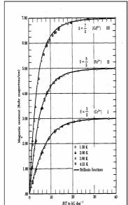
Рис. 3.1. Кривые намагниченности парамагнитных солей |содержащих ионы Cr<sup>3+</sup>, Fe<sup>3+</sup>|
