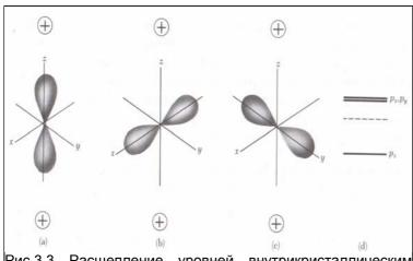
Рис.3.3 Расщепление уровней внутрикристаллическим полем
