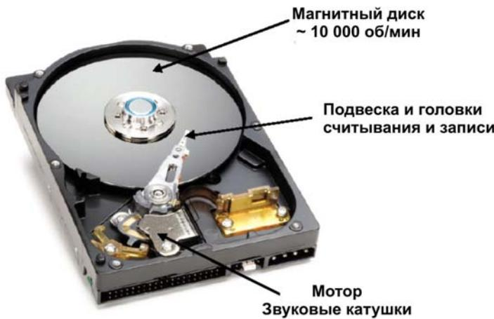
Рис.14.3. Устройство накопителя на жестких дисках
