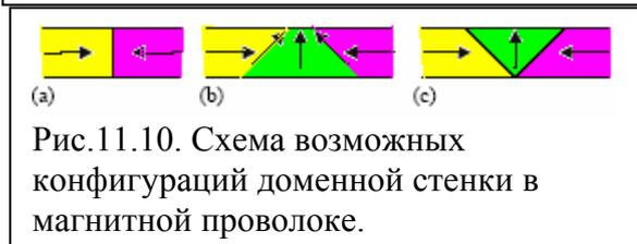
Рис.11.10. Схема возможных конфигураций доменной стенки в магнитной проволоке.
