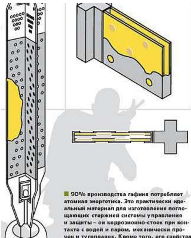
■ 90% производства гафния потребляет атомная энергетика. Это практически идеальный материал для изготовления поглощающих стержней системы управления и защиты — он коррозионно-стойк при контакте с водой и паром, механически прочен и тугоплавок. Кроме того, его свойства
