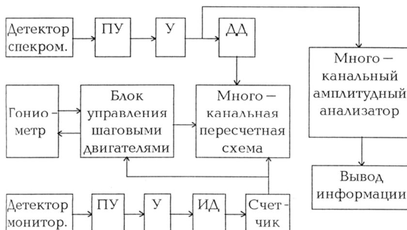
Рис.24. Блок-схема экспериментальной установки POP. ПУ – предусилители, У – усилители, ИД – интегральный дискриминатор, ДД – дифференциальный дискриминатор.
