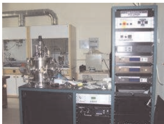
Рис. 8. Установка магнетронного напыления AJA. На заднем плане установки по термохимической обработке материалов
